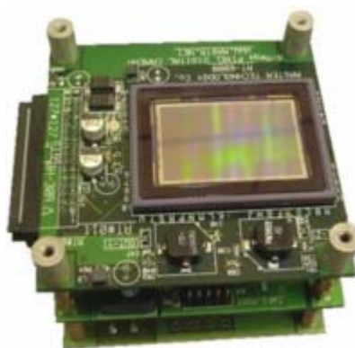
Цифровая камера RT6000DC (ПЗС матрица Philips FTF3020M)
